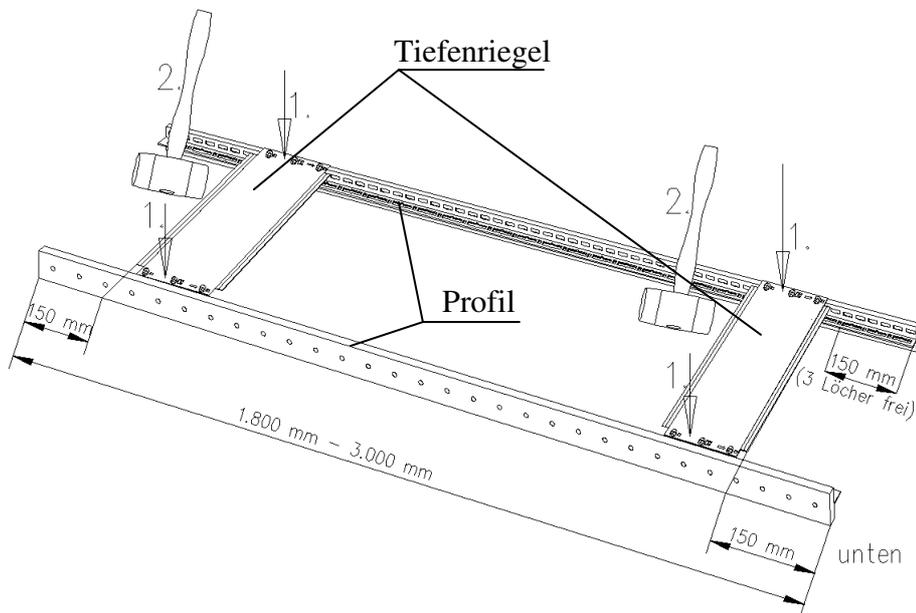
Der untere Tiefenriegel muss sich in einer Höhe von 150 mm über dem Boden (3 Lochungen frei lassen) befinden. Beim oberen Tiefenriegel halten Sie ebenfalls einen Abstand von 150 mm (3 Löcher frei lassen) ein.
