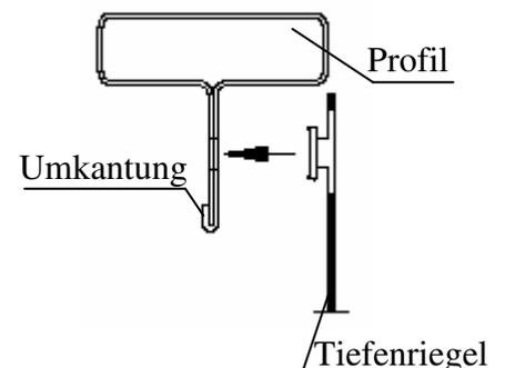
2. Nach dem Einschlagen der Tiefenriegel müssen Sie diese sichern. Zu diesem Zweck werden die Sicherungslaschen mit einem Schraubenzieher ca. 1 mm eingedrückt.
